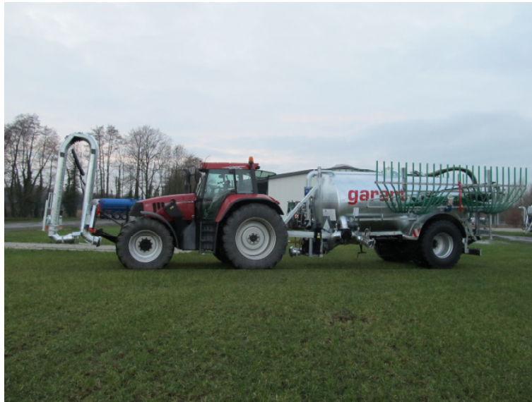
Bild 3: Der Ansaugrüssel wird mit dem Weiste-Dreieck in der Front-hydraulik transportiert.
