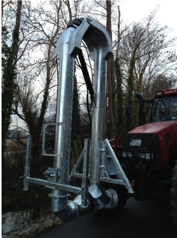
Bild 1: Ansaugrüssel NW 200 für die Fronthydraulik mit Belüftungsöffnung, Abstellstützen und Halterung für Warntafel.
