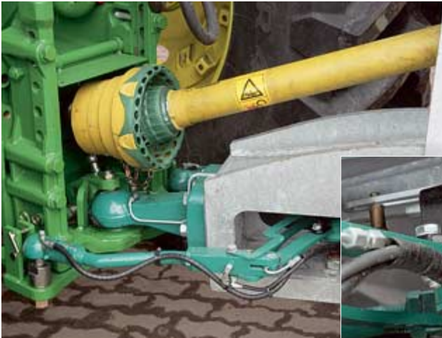
Das Gelenk-Viereck aus den K-50-Kupplungen, den Lenkstangen und der Verbindungsstange im Deichselkasten bewegt einen Geberkopf, der mit einem Drehpotenziometer den Lenkwinkel ermittelt.
