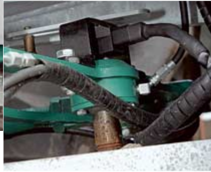
Das Gelenk-Viereck aus den K-50-Kupplungen, den Lenkstangen und der Verbindungsstange im Deichselkasten bewegt einen Geberkopf, der mit einem Drehpotenziometer den Lenkwinkel ermittelt.
