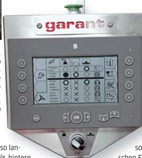
Auf dem Bedienterminal SmartControl wird eine tabellarische Darstellung der möglichen Lenkarten angezeigt. Der Drehschalter unten ermöglicht die Auswahl von Feld-, Straßen- oder Hoffahrt.
