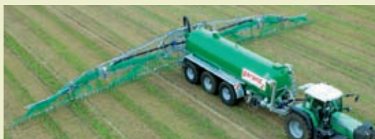
Распределитель с системой навесных шлангов Vogelsang SwingMax. Рабочая ширина от 21 до 33 м.
