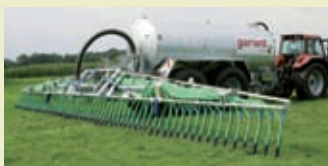
Распределитель с башмачной системой навесных шлангов Bomech Greenstar - multi. Рабочая ширина от 12 до 18 м.
