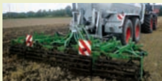
Распределитель с башмачной системой навесных шлангов Bomech Greenstar-flex. Рабочая ширина от 5.30 до 8.60 м.
