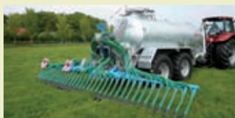
Распределитель с башмачной системой навесных шлангов Bomech Greenstar-flex. Рабочая ширина от 5.30 до 8.60 м.
