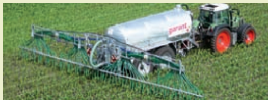
Распределитель с системой навесных шлангов Vogelsang SwingUp Рабочая ширина от 9 до 18 м.
