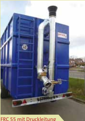
FRC 55 mit Druckleitung und Andocktrichter
