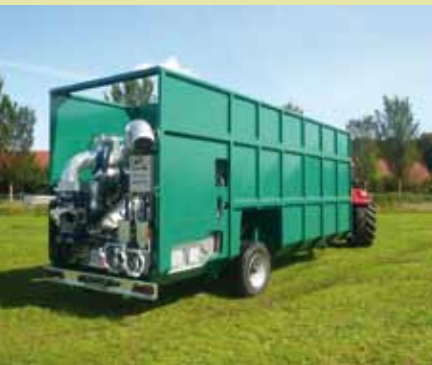
Feldrandcontainer mit Pumpstation
