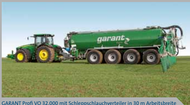
GARANT Profi VQ 32.000 mit Schleppschlauchverteiler in 30 m Arbeitsbreite
