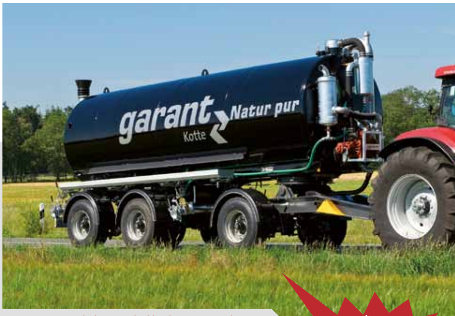
TAV 26 mit KTL-Beschichtung und Schlauchwannen aus Aluminium
