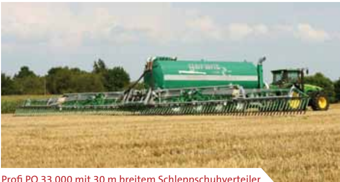
Profi PQ 33.000 mit 30 m breitem Schleppschuhverteiler
