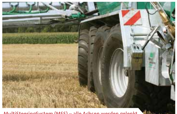
MultiSteeringSystem (MSS) – alle Achsen werden gelenkt
