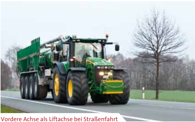
Vordere Achse als Liftachse bei Straßenfahrt
